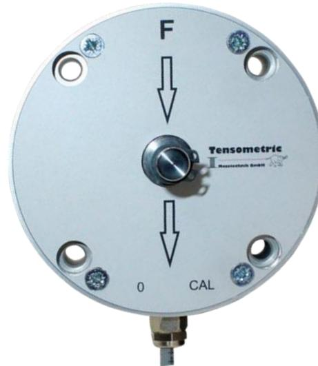
Der **M-1355-X** ist ein präzises und zuverlässiges Messinstrument mit hohem Überlastschutz und großer Langzeitstabilität. Er liefert ein Ausgangssignal von 0 bis  $\pm 10V$  (optional 4-20mA), entsprechend 0 bis  $\pm 100\%$  der Nennlast. Zur Einstellung des elektrischen Nullpunktes und der Verstärkung (Kalibrierung), befinden sich von außen zugänglichen Potentiometern.
