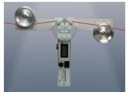
Die Geräte der **Tensometric Handy-LC** und **HANDY-LWL**– Serien sind handliche und zuverlässige elektronische Messinstrumente zur schnellen Überprüfung von Zugkräften in Maschinen mit laufenden Materialien.
