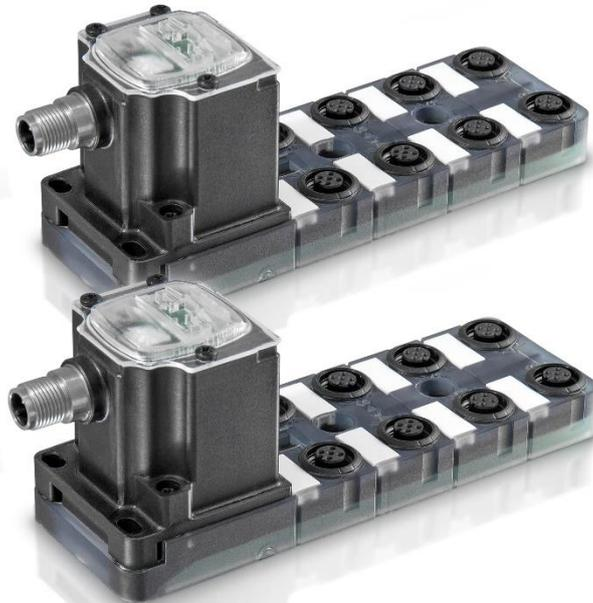
Mit dem Produkt 4CH-I/O-BT werden Analogsignale 0-10V oder 4-20mA - per Bluetooth übertragen. Es bildet die Schnittstelle zwischen Messwertempfänger und Steuerung und besteht aus 2 Modulen. Einem Master, welcher außerhalb der Maschine als Empfänger dient und dem Slave, der in der Maschine in der Nähe des Messkopfes sitzt und die Sensordaten an den Master sendet. Von diesem können die Daten in der Maschinensteuerung als Analogsignale weiter verarbeitet werden.
