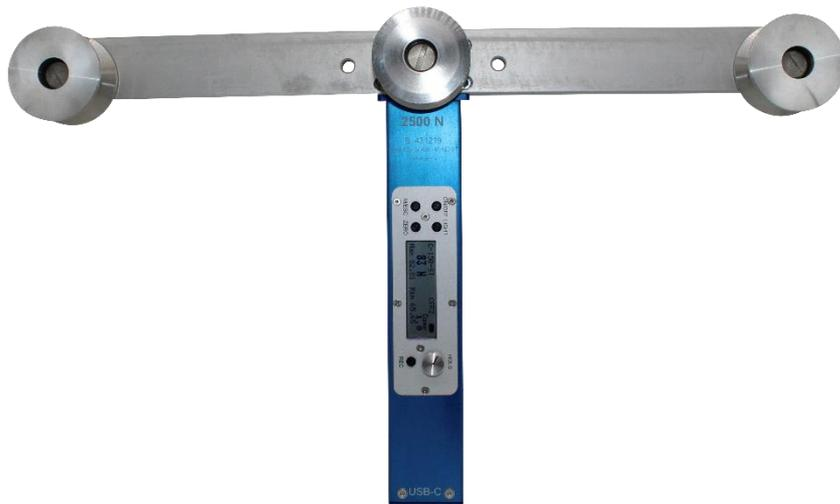
**Beschreibung:** Elektronisches Zugkraftmessgerät, akkubetrieben, ideal für Kurzzeitmessungen. Einhand- Bedienung, direkte Ablesung der gemessenen Zugkraft. Einfache Materialeinfädung in das laufende Material.
