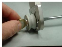
Ein Mitdrehen der Führungsrolle ist mit einer in den Rollenschlitz gehaltenen Münze zu verhindern.
